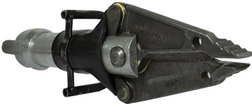
En primer lugar, esta herramienta contiene una cizalla que es un instrumento pensado para las operaciones de rescate que se dan en los accidentes automovilísticos. Se usa en estas situaciones porque la cizalla hidráulica permite atravesar, remover y abrir elementos de gran peso y volumen, por lo que es conocida también como mandíbula o quijada de la vida.
