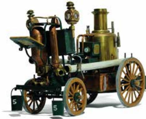
Antes de la llegada de los carros a vapor, los primeros bomberos debieron apagar incendios utilizando bombas a palanca, generando la presión necesaria para empujar el agua por medio de un tremendo esfuerzo humano. Los nuevos carros representaban un adelanto respecto a estas antiguas bombas, puesto que ahora la energía provenía del vapor.
